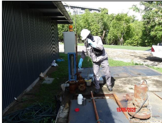
รูปที่ 3.1 การเก็บตัวอย่างคุณภาพน้ำทิ้ง บริเวณ บ่อพักน้ำทิ้งก่อนระบายออกนอกโครงการ
